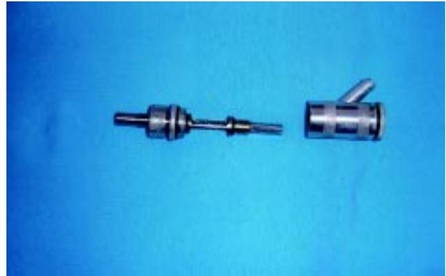
Figura 3 - Motores elétricos rotatórios de bateria recarregada, tendo na sua extremidade um canhão para o encaixe na câmara de vácuo.
