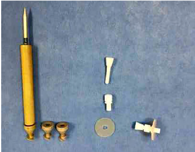
Figura 2. Portais com design adequados para as variações de diâmetros dos probe ultrassônicos. Fonte: Autor do trabalho (2018).
