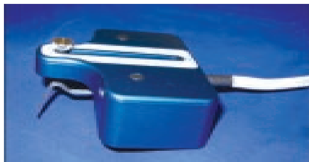
Figura 6 - Transdutor de força do PSSD.
